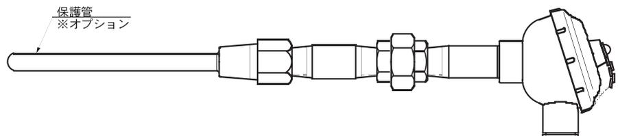
オプションの保護管や既設の保護管と組み合わせる事で、配管挿入タイプとして使用できます。
