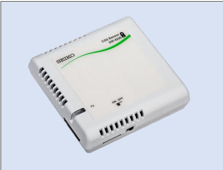
本製品は、無線センサネットワークシステムにおいて、CO2の濃度を測定し、測定したデータを送信するCO2ノードです。
