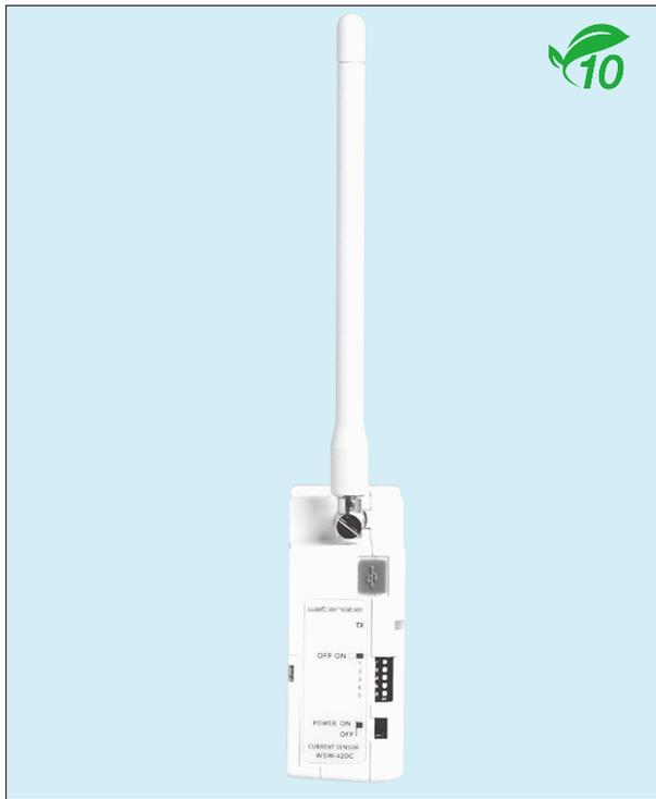
本器は、無線センサネットワークシステムにおいて、分電盤や配電盤の電源ケーブルに流れる電流波形をCTで検出し、電流値、仮想電力、仮想電力量を無線送信する電流センサーノードです。
