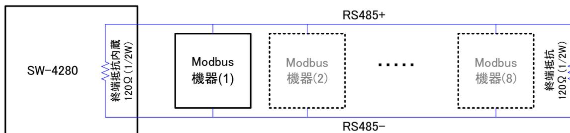
図 7 電力量センサとの接続結線図
