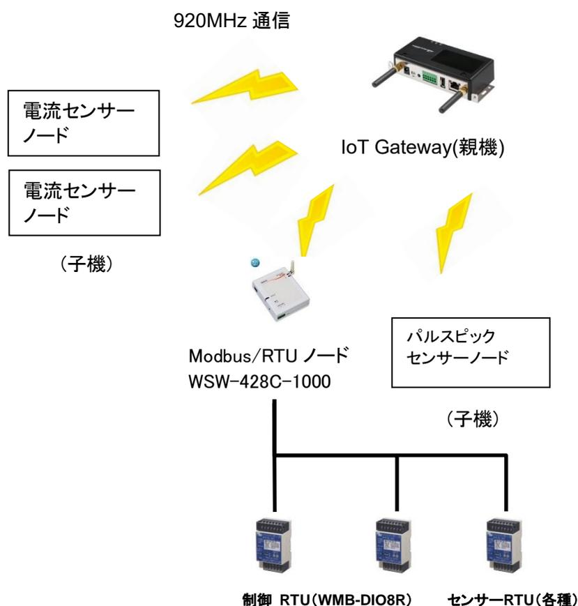
図 2 IoTGateway から制御する場合の構成例
