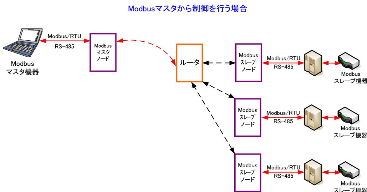
図 3 Modbus マスタから制御する場合の構成例
