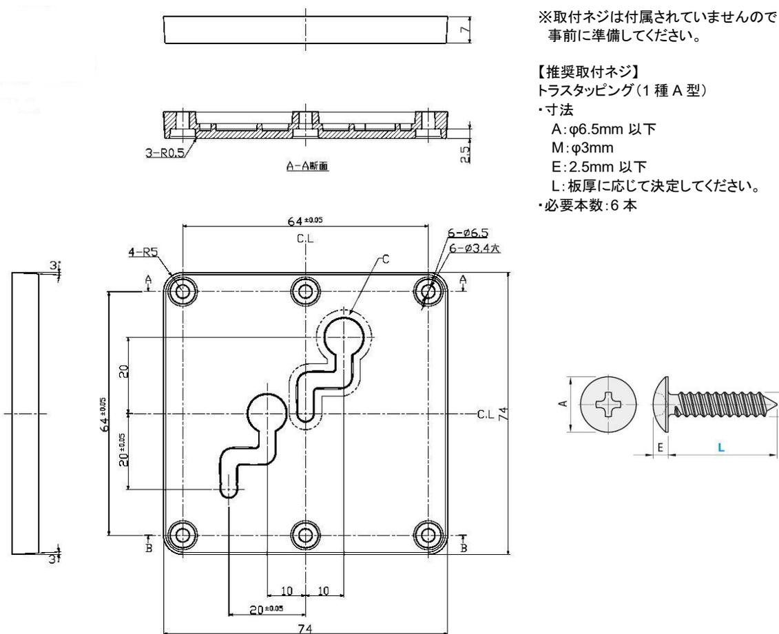
図 6 取付けプレートの外形寸法図
