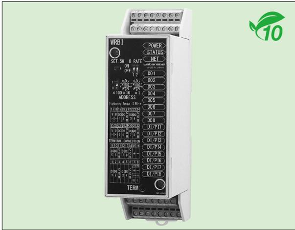
本器は、リレー接点またはオープンコレクタのON/OFF信号入力と、24VトランジスタのON/OFF信号を出力するBACnet MS/TP対応のモジュールです。
