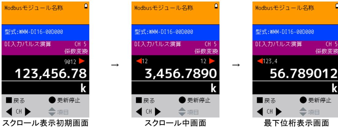
図9.15 DI表示(変換係数)画面のスクロール表示
