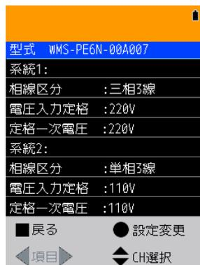
図11.3 電圧系統表示画面
