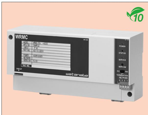
本器は1台で、複数回路の電力諸量を計測し、ツイストペア線経由でパソコンなどに計測値を伝送するユニットです。従来のWRMC-PE型を30Aに対応させ、低負荷時でもより高精度の計測ができるようになりました。また、専用の小形分割CTを採用し、作業の簡素化を図りました。専用の設定表示器(WRMC-DM01 別売品)を接続すれば、CT、PT (VT) の1次定格の設定や表示などが可能となり、設置時の設定や運転時の計測値の確認が容易にできます。また、内部パラメータの設定は、LonMaker for Windowsからも行うことができます。バインディング、通信パラメータおよび通信機能の設定は、LonMaker for Windowsで行います。
