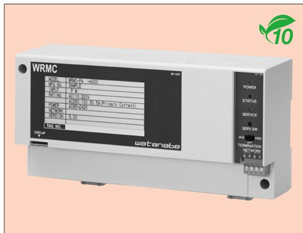
本器は1台で、複数回路の電力諸量を計測し、ツイストペア線経由でパソコンなどに計測値を伝送するユニットです。コンパクトなサイズに納め、DIN レール取り付けを可能としたため、設置工数およびスペースの削減ができる上、専用の小形分割CTを採用し、作業の簡素化を図りました。このため点数が多い電気設備や、機器レベルの計測をローコストで実現できます。専用の設定表示器（WRMC-DM01 別売品）を接続すれば、CT、PT（VT）の1次定格の設定や表示などが可能となり、設置時の設定や運転時の計測値の確認が容易にできます。また、内部パラメータの設定は、LonMaker for Windowsから行うことができます。バインディング、通信パラメータおよび通信機能の設定は、LonMaker for Windowsで行います。
