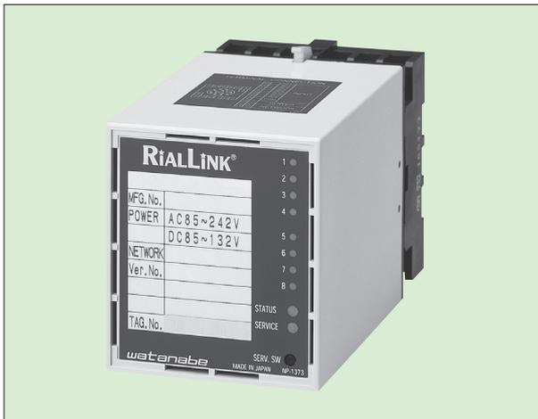
本器はパルス出力される機器からの2点、4点または8点の信号を入力し、それぞれを積算するプラグインタイプのユニットです。積算したデータはツイストペアケーブルのネットワークに接続したパソコンなどの上位機器から読み込むことができます。アドレス設定、機能設定はネットワーク上のパソコンから行います。通信は1対のツイストペアケーブルで行うので、従来の伝送に比べ省配線と工数削減が図れます。
