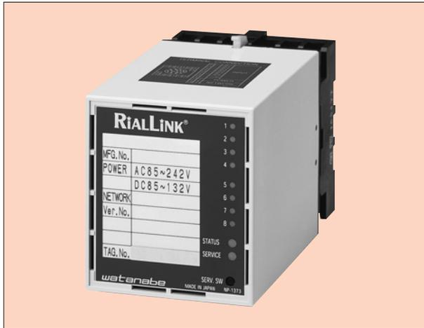
本器はパルス出力される機器からの2点、4点または8点の信号を入力し、それぞれを積算するプラグインタイプのユニットです。積算したデータはツイストペア線のネットワークに接続したパソコンなどの上位機器から読み込むことができます。また、付番03のモジュールはDI（デジタル入力）のSNVTを持っていますので、デジタル入力モジュールとして使用することもできます。バインディング、通信パラメータおよび通信機能の設定は、LonMaker for Windowsで行います。通信は1対のツイストペアケーブルで行いますので、従来の伝送に比べ省配線と工数削減が図れます。
