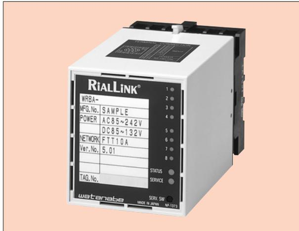
本器はリレー接点、オープンコレクタまたは24VトランジスタのON/OFF信号を出力するユニットです。バインディング、通信パラメータおよび通信機能の設定は、LonMaker for Windowsで行います。通信は1対のツイストペアケーブルで行いますので、従来の伝送に比べ省配線と工数削減が図れます。
