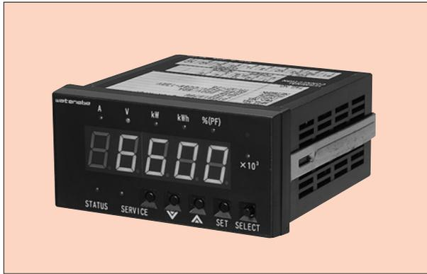
本器は三相3線または三相4線、単相3線、単相2線の電力諸量を計測し、デジタル表示をするとともに、その計測値をLONWORKS®に伝送するものです。従来のWKDシリーズに比べ大幅な小形化と低価格を実現しています。さらに、専用小形分割CTを標準で用意しましたので、設置スペースが限られた分電盤、既設盤、機械装置の計測に好適です。PDタイプはデジタル入力2ch付きですので、状態監視、回数積算、ON時間積算が可能です。
