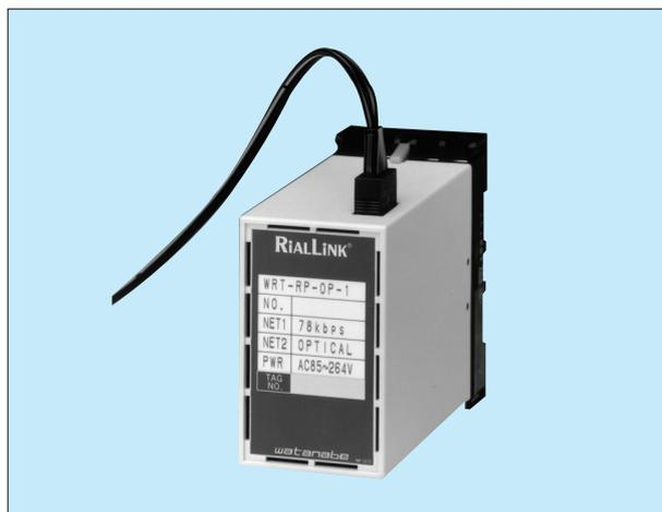
外来ノイズの激しい環境下で、リアルリンクのネットワークの使用を可能にする光リピータです。本器2台を1組にして、その間をハードプラスチックラッド光ファイバケーブルをコネクタ接続して使用します。
