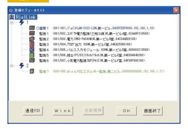
登録済みの全モジュールと登録内容を表示します。 通信テストにより、通信状態に異常があるモジュールの特定が可能です。
