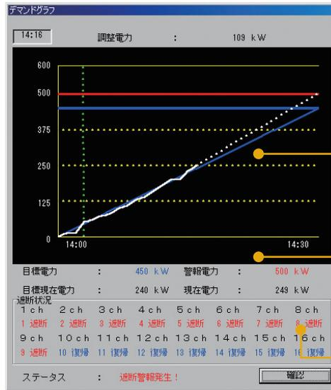
白線が現在までの使用電力量で、点線が今後の予測電力量です。目標設定した青線を超えないよう、警報や制御信号を出力します。
