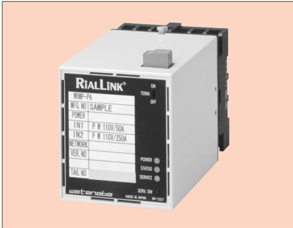
本器は三相3線と单相3線回路の電力諸量を同時に計測できますので、動力と電灯が併設された分電盤の計測に適しています。ツイストペア線経由で、計測値をパソコンなどに伝送します。また、プラグイン式ですから、設置とメンテナンスの効率が図れます。さらに、専用の小形分割CTを標準で用意しましたので、設置スペースが限られた分電盤や既設盤の計測に好適です。バインディング、通信パラメータおよび通信機能の設定は、LonMaker for Windowsで行います。
