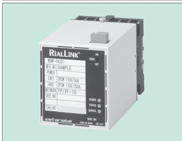
本器は2回路の電力諸量を計測し、ツイストペアケーブル経由で、計測値をパソコンなどに伝送するものです。しかも同じネットワークに最大 62 台接続できますので、点在する電気設備における計測に適しています。また、プラグイン構造のため、設置とメンテナンスの効率が図れます。さらに、専用小形分割 CT 使用により、設置スペースが限られた分電盤、既設盤の計測に好適です。各種パラメータと通信機能の設定は、ネットワーク上に接続したパソコンから行える様になっています。
