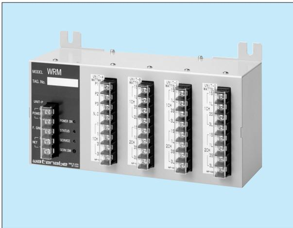
本器は、特に分電盤レベルの電力計測に適した専用の小形分割 CT を使用し、7 回路の電力諸量を計測しツイストペアケーブル経由でパソコンなどに計測値を伝送するものです。しかも同じネットワークに最大 496 台接続できますので、点数が多い電気設備の計測に適しています。各種パラメータと通信機能の設定は、ネットワーク上に接続したパソコンから行える様になっています。
