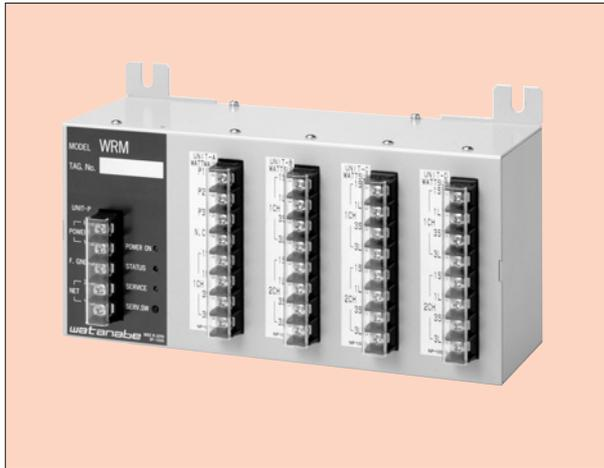
本器は多点の電力諸量を計測し、ツイストペア線経由で、計測値をパソコンなどに伝送するものです。点数が多い電気設備における計測に適しています。バインディング、通信パラメータおよび通信機能の設定は、LonMaker for Windowsで行います。
