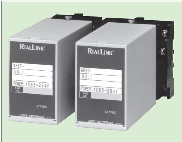
本器は1量、2量、4量または8量の直流信号を入力するユニットです。アドレス設定はネットワーク上のパソコンから行います。通信は1対のツイストペアケーブルで行うので、従来のアナログ伝送に比べ省配線と工数削減が図れます。
