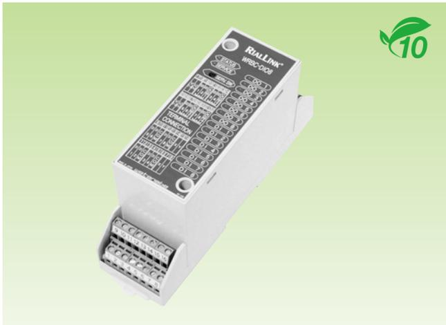
本器はリレー接点またはオープンコレクタのON/OFF信号入力と、リレー接点またはオープンコレクタ、24VトランジスタのON/OFF信号を出力するユニットです。停復電時出力保持機能搭載型を用意しております(DIO8XF/YF)。バインディング、通信パラメータおよび通信機能の設定は、LonMaker for Windows等で行います。通信は1対のツイストペアケーブルで行いますので、従来のアナログ伝送に比べ省配線と工数削減が図れます。
