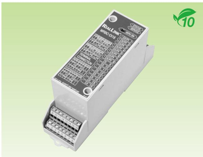
本器はリレー接点またはオープンコレクタのON/OFF信号を入力するユニットです。またパルス出力される機器からの信号（最大8点）を入力し、積算することもできます。積算は回数積算かON時間積算のいずれかが選べます（DI16DFは機器警報積算のみ）。
