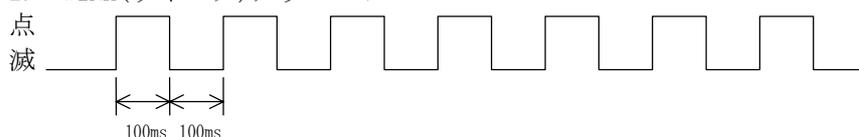
LonMaker for Windowsからの操作で点滅を開始します。点滅時間は約10秒間です。これにより中央にあるパソコンからコンフィグレーションされたモジュールを、現場で確認する事ができます。
