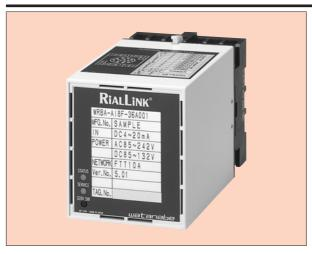
本器は8量の直流信号を入力するユニットです。バインディング、通信パラメータおよび通信機能の設定は、LonMaker for Windows で行います。通信は1対のツイストペアケーブルで行いますので、従来のアナログ伝送に比べ省配線と工数削減が図れます。
