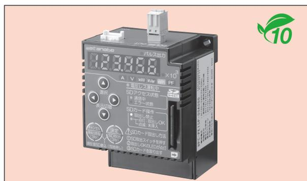
本器は、交流電圧入力と専用CT による交流電流入力から電力計測を行い、電力要素諸量をSDカードにCSV形式で蓄積します。同時に有効電力量を単位パルス (オープンコレクタ) で出力するモジュールです。
