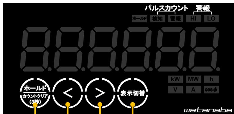
いずれかのスイッチを押すことで自動消灯直前の測定画面に復帰します。
