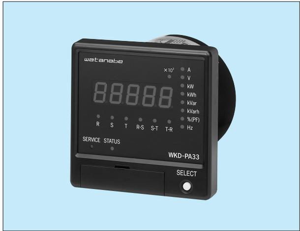
本器は単相2線、単相3線、三相3線の電力諸量を計測し、デジタル表示をするとともに、その計測値をネットワーク経由で、パソコンなどに伝送するものです。WKD-PA (電力監視モジュール)の測定要素にプラスして、最大有効電力、最大電流 (各相) が計測、表示できます。
