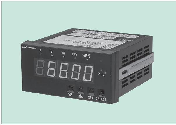
本器は三相3線または三相4線、単相3線、単相2線の電力諸量を計測し、デジタル表示をするとともに、有効電力量を単位パルスで出力するものです。専用小形分割CT使用により、設置スペースが限られた分電盤、既設盤、機械装置の計測に好適です。各種パラメータ設定は本体前面のキースイッチで行えます。また、パルス出力される電力量をリアルリンクのカウンタ入力モジュールやPLCに取り込み、パソコンを利用した使用電力量のモニタリングができます。
