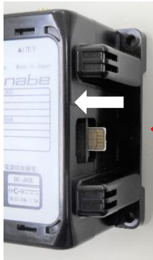
SIM カードの差し込み
