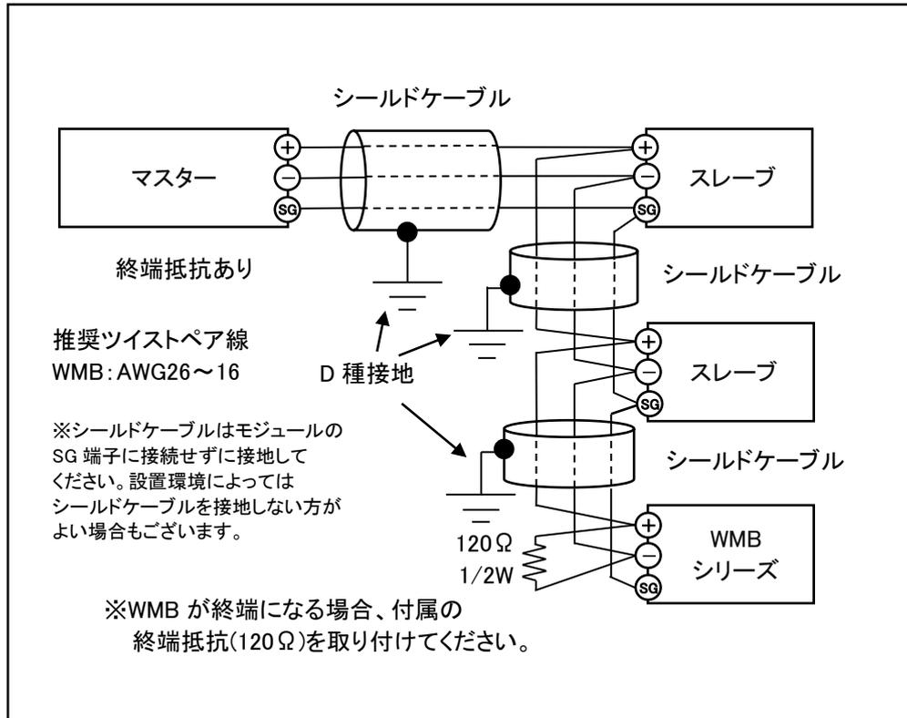
図 2.9 WMBシリーズのModbus接続
