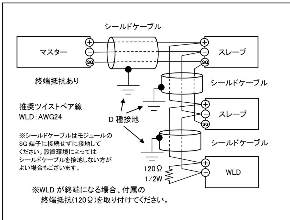
図 2.7 WLDのModbus接続
