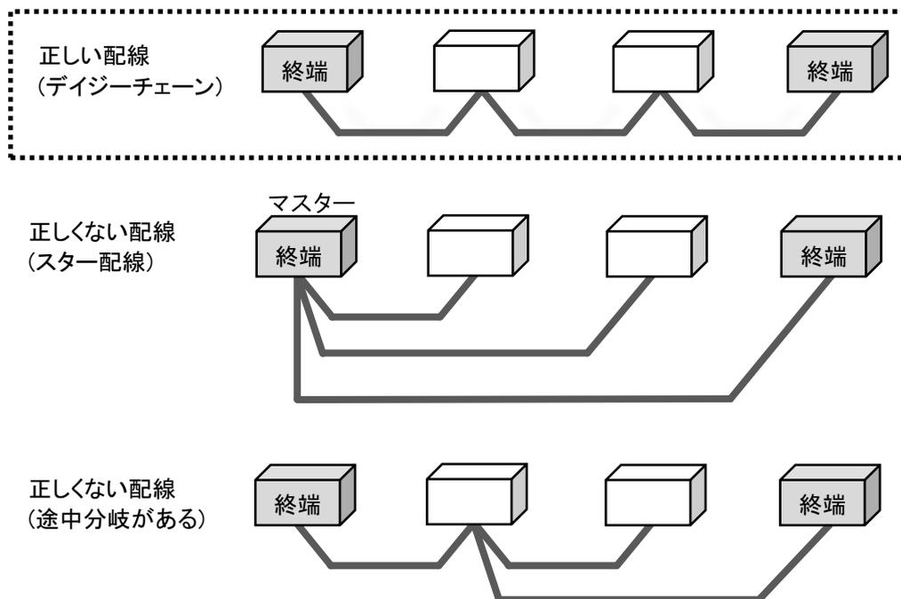
図 2.1 Modbus通信の配線
