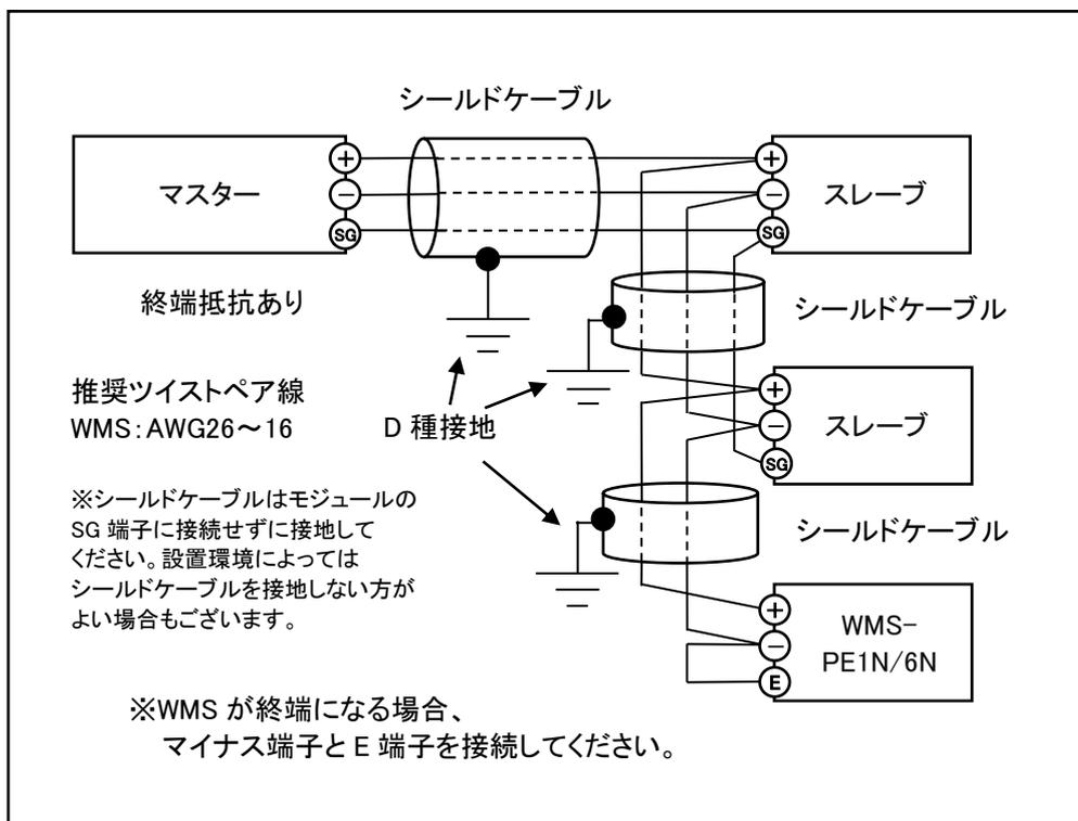
図 2.8 WMS-PE1N/6NのModbus接続
