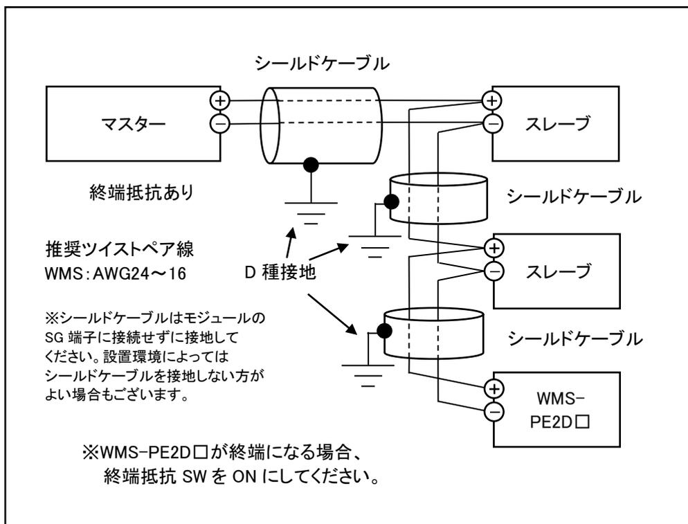
図 2.10 WMS-PE2D□のModbus接続
