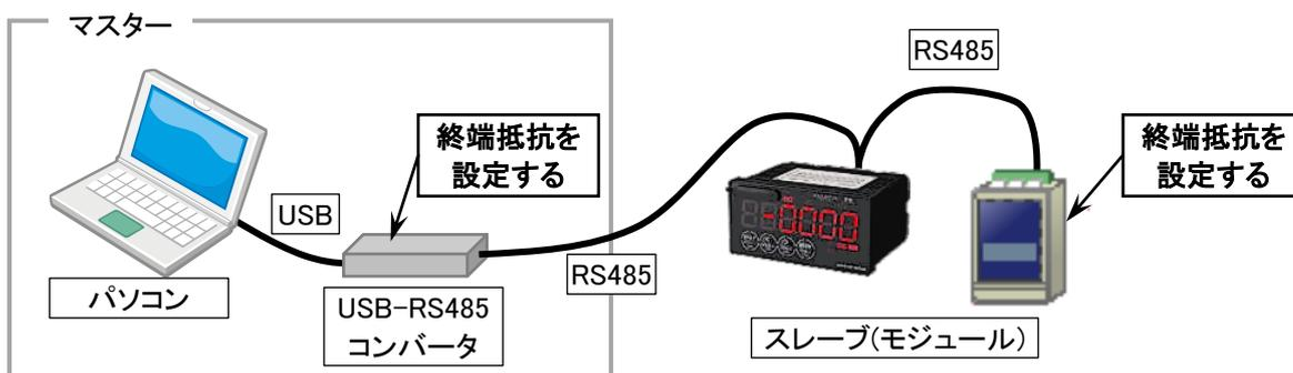
図 2.6 USB-RS485コンバータ使用時の終端抵抗
