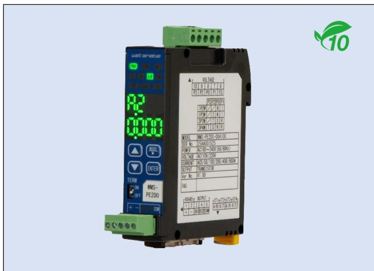
本製品は、交流電圧入力と交流電流入力(専用CT)から電力計測を行い、計測した各要素のデータをRS-485(Modbus RTU)通信で上位デバイスに送信する電力量計です。設定は本体前面の操作もしくはModbus設定ツールにて行うことができます。渡辺電機工業製のIoTゲートウェイ「Econo・DataChef」と連携させ、エネルギー監視システムを容易に構築することができます。
