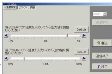
同様に、端子2,3,4にスパン温度相当を入力し、矢印ボタンを押して出力を調整してください。直接スライドバーを調整することもできます。
