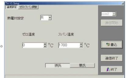
▼マークをクリックするとリストが表示されます。(右図)お使いになる熱電対をクリックしてください。
