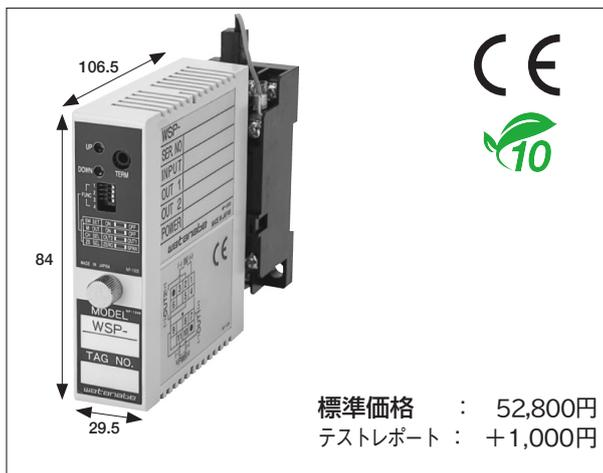
本器はJIS準拠の熱電対(サーモカップル)と組み合わせて使用する小形プラグイン式の温度変換器です。CPUを搭載したデジタル型で、専用設定ツールにてセンサ種別、入力温度レンジ、出力レンジ、各種パラメータ変更及びモニタリング、模擬入出力を現地で行うことができます。リニアライザ、冷接点保証回路、センサ断線を警報するバーンアウト回路を装備しています。
