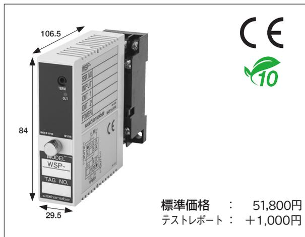
本器は入力パルス列信号を分周することによって、ご希望のスケールリングを施し、波形整形、オプトアイソレート処理をしたパルスを出力する、小形プラグイン式のパルス変換器です。CPUを搭載したデジタル型で、専用設定ツールにて分周設定、パルス幅、出力反転／非反転、各種パラメータ変更及びモニタリング、模擬入出力を現地で行うことができます。
