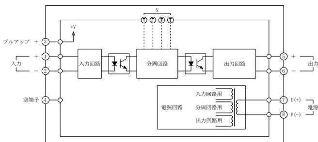
端子①、②より入力された信号は、入力回路で波形整形されフォトカプラで絶縁された後、分周回路へ入力されます。分周回路では4桁のデジタルスイッチで設定された値の分周を行い、その出力を再びフォトカプラで絶縁して出力回路に入力し、端子⑤、⑥より出力されます。
