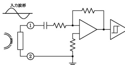
電磁ピックアップセンサのように低速回転時には信号レベルが小さく、回転数の増加と共に信号レベルが増大するような信号源に適した入力回路で、0Vを中心に200mVp-pから50Vp-pまで入力可能です。なお、本入力仕様の入力インピーダンスは100kΩ以上です。
