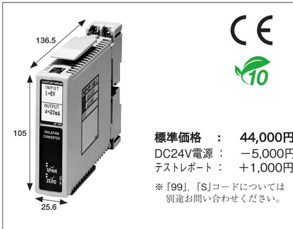
本器は、入力-出力-電源間を相互に絶縁する、スリムなプラグイン式のアイソレータです。様々なレベルの信号を、他の回路から絶縁するとともに、計測制御システム内で統一して扱える信号に増幅・変換するもので、ノイズ対策に威力を発揮します。
