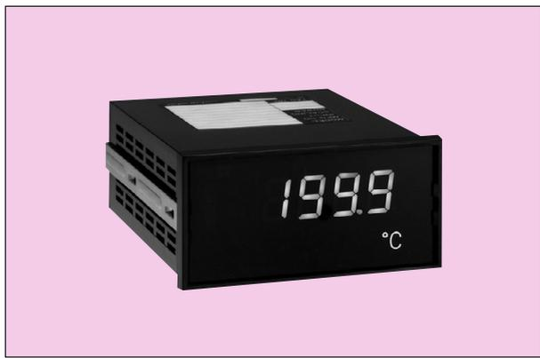
本器は、白金測温体からの信号を受けて、温度をデジタル表示するパネル取付形のデジタル温度計です。測温体とは電氣的に絶縁されたアナログ信号を出力可能ですから、同時に信号変換器の役割を果たします。また、試運転時に威力を示す模擬信号を出力できます。
