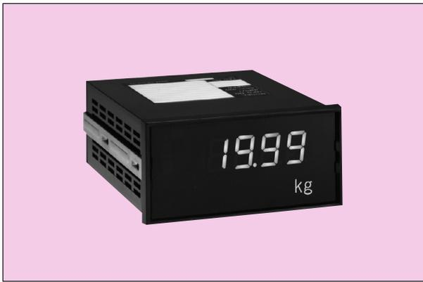
本器は、ロードセルからの検出信号を受けて、重量等の物理量として直読表示する、パネル取付形のデジタルメータです。ロードセル側とは電氣的に絶縁されノイズに強いアナログ信号を出力可能ですから、同時に信号変換器の役割を果たします。また、試運転時に威力を示す模擬信号を出力できます。
