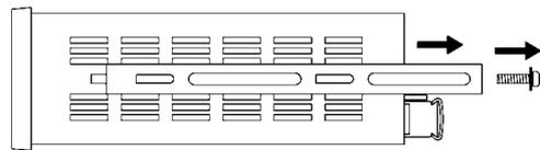
2. 取付金具を外した状態で、本器を取り付けパネルの表面からパネルカットの穴に差し込んで下さい。
