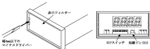
2. 小数点、ゼロブランキング、桁下げシフトを設定する場合、製品正面のDIPスイッチの該当する番号をONにして下さい。
