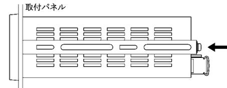
取付金具締め付け時のトルクは35 [cN・m] 以下にして下さい。
