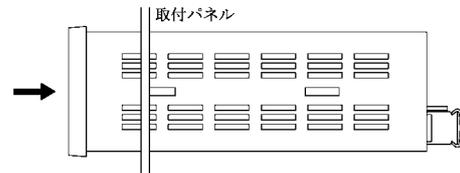
3. 製品の両側面の溝に取付金具を差し込んでから外した固定ビスをしっかりと締め込んで下さい。
