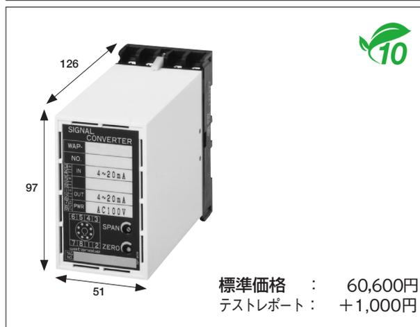
本器は、トランスミッタと組み合わせて使用できるプラグイン形の信号分配器です。現場のトランスミッタにDC電源を供給するとともに、トランスミッタが発信する4~20mA信号を監視・制御機器への入力に適した信号に変換するものです。また、入出力信号間を絶縁するためのアイソレータを内蔵しております。
